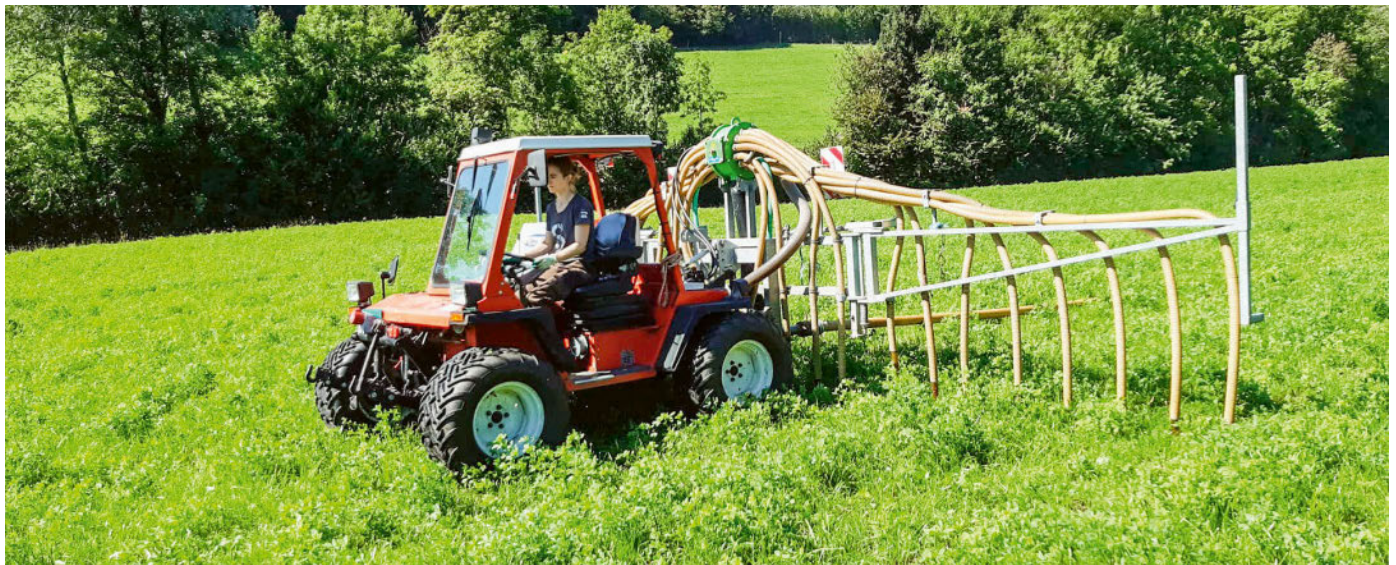
Der elektrifizierte Metrac im Einsatz
