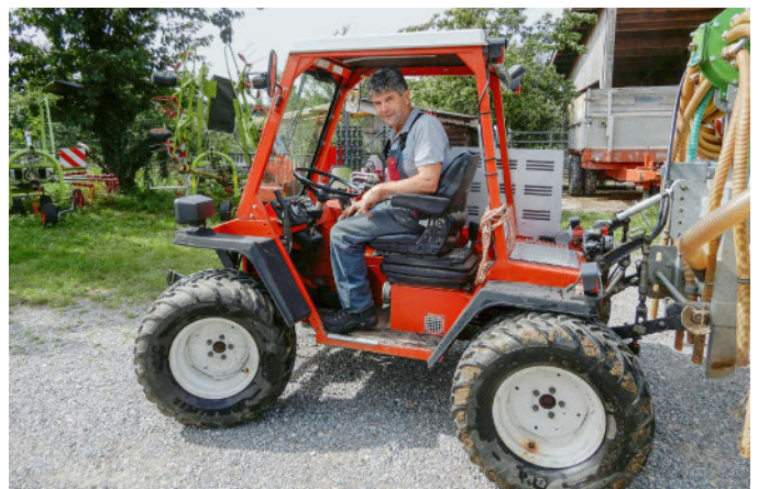
Guido Winterberg mit dem elektrifizierten Metrac Die Batterie speichert 40 kWh
